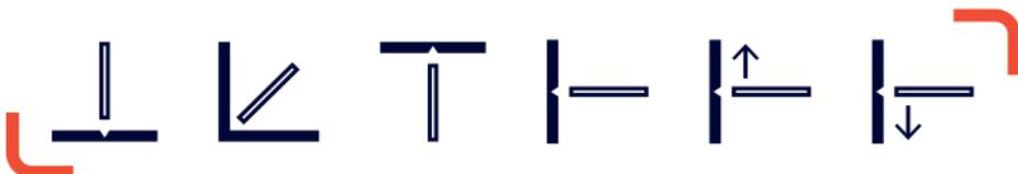
\*при монтажной сварке возможна работа во всех пространственных положениях без изменения сварочного тока.
